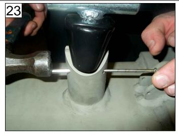
DRIVE ROLL PINS THROUGH FLUSH ON BOTH ENDS
