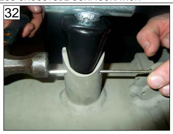
DRIVE ROLL PINS THROUGH FLUSH ON BOTH ENDS
