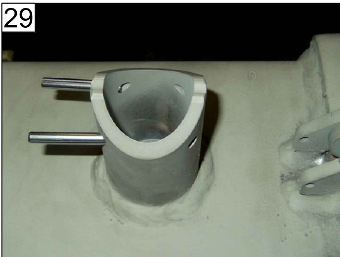
INSERT ROLL PINS REFERENCE 25461-1 ITEM 10
